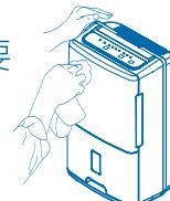
4 下列物品請勿使用，以避免侵蝕塑膠外殼。圖料調薄劑、揮發油、石油、洗衣粉、亮光粉、強鹼洗潔劑、熱水、酸溶液、毛刷等。
