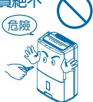
勿將電源線損壞或使之破損、加工、過度彎曲、拉扯、扭轉或放置重物等動作
