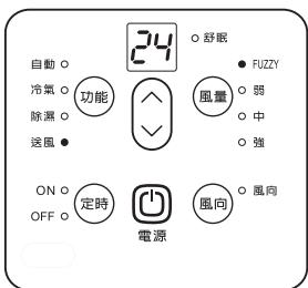
● 送風模式時，因壓縮機處於停止狀態，故使用遙控器（或面板控制器）調整溫度時，無法影響送風模式時的出風溫度。
