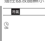
預約開機設定後冷氣機將自動開機，冷氣機運轉模式設定為前次關機前之設定。
