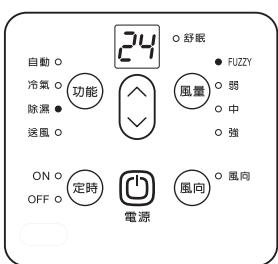
● 除濕是以降低房間濕度為目的的冷氣運轉，此時風量由微電腦自動控制無法調整。
