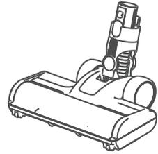
1. 將絨毛地刷周圍打結的毛髮、毛線、棉絮等用剪刀剪斷。
