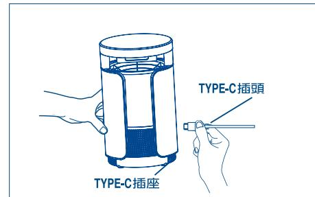
3. 將TYPE-C插頭完全插入到機背部的TYPE-C插座內、進入待機狀態。
