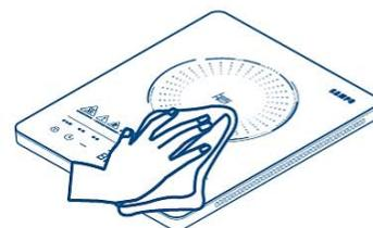
■ 電磁爐的進氣孔、散熱孔表面若附著灰塵或細屑時，可使用棉花棒沾少許稀釋後的中性清潔劑，輕拭進氣孔、散熱孔縫隙。
