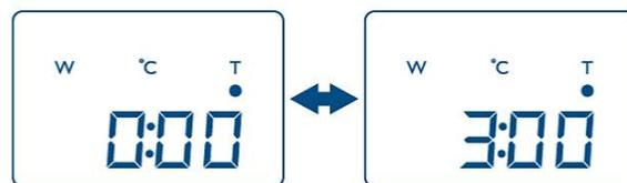
**2** 定時設置中，顯示面板閃爍欲設定時間，5 秒內若沒有按鍵操作，則自動進入定時關機模式，面板顯示燈常亮，交替顯示火力值（溫度值）和剩餘工作時間。
