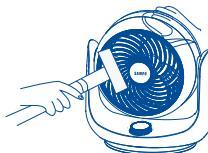
2. 若前網、扇葉及後網處附著過多的異物或粉塵，將影響出風效果。請先使用螺絲起子卸下①和②處的螺絲；同時按住③和④處的倒扣並向前推，再按住⑤和⑥處的倒扣並向前推取下前網（圖一）
