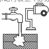
● 為確保冷氣機能夠發揮最大的冷氣能力、省電效果，保持新鮮的室內空氣，請每隔1～2週，務必清洗過濾網一次。
