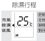
③ 除濕模式時，風量與溫度由微電腦控制無法調整。
