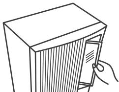
● 清洗過濾網，請使用清水、中性洗潔劑或吸塵器，洗清後晾乾再裝上（切勿烘烤或日曬）。
