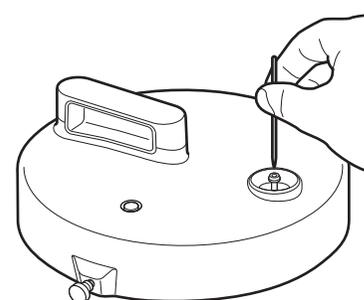
只要先拆下墊圈，便可將壓力顯示桿從鍋蓋本體上拆下清潔。
