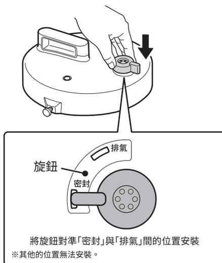
裝好壓力切換閥後，請輕拉看看，以確認壓力切換閥不會脫落。
