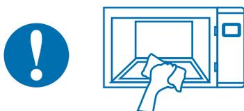
烹調中發生冒煙或起火現象時，請不要立刻拉開爐門，應先停止操作及拔除電源線，將保險絲或電流斷路器之開關關閉。
