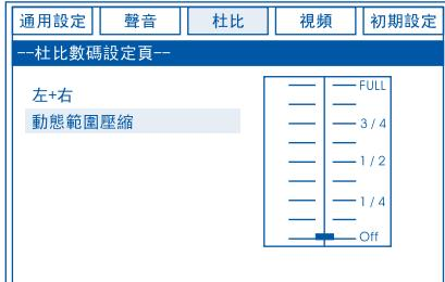
動態範圍調整是以小音量在深夜觀看動態範圍大的電影節目而小細節的音效無法呈現時，調整動態壓縮可以將小細節部分的音效提高音量為準，如此可以不影響鄰居的安寧，且不會降低聲音的品質來觀賞，請用方向鍵移動至右側後再移動上下鍵來調整需要的範圍，往往“FULL”方向調整時會壓縮較多，往往“OFF”方向為原來未壓縮的效果。
