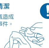
• 插頭上若塵埃堆積，會因濕氣造成絕緣不良，引起火災的意外事件。
