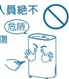
勿將電源線損壞或使之破損、加工、過度彎曲、拉扯、扭轉或放置重物等動作
