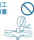
• 會造成電源線破損導致火災或觸電受傷的意外事件。
