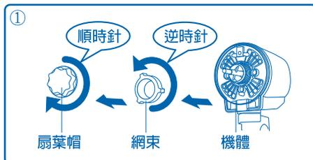
2. 請將後網上的 3 個圓孔，對準並置入馬達前殼 3 個凸柱的定位部，再將網束套入馬達前殼螺牙處，以順時針旋轉鎖緊，如圖②所示。
