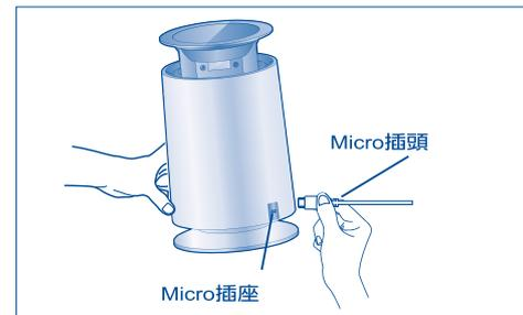
3. 將Micro插頭完全插入到機背部的Micro插座內、進入待機狀態。
