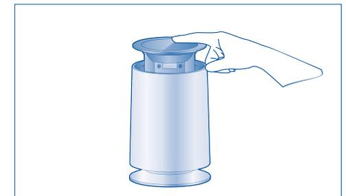
4. 插上電源後，機器通電進入待機狀態，觸摸一次機器頂端中央的開關按鍵，指示燈“持續”亮起，進入運行狀態。
